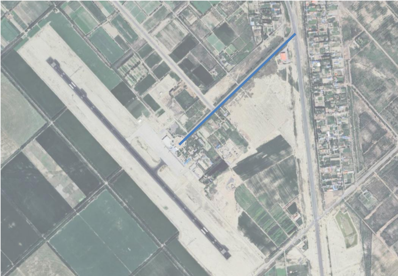
机场新建 DN400 排水主管线
